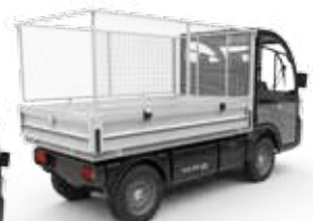
Vaste of kippende laadvloer met gaasrekken
